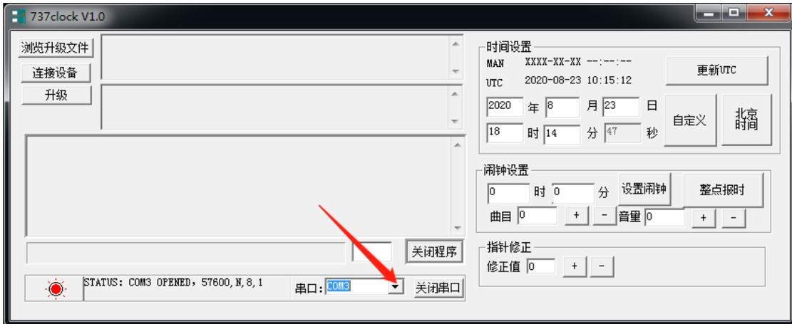
点击这个下拉菜单, 选择正确的端口号, 比如本机是 COM2, 就要选择为 COM2, 而不是 COM3, 完成后, 点击连接设备, 右边框里会显示 737 时钟的信息, 如下图所示:
